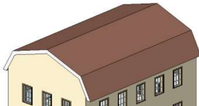
גג ששורטט באמצעות הפקודה Roof by Extrusion
